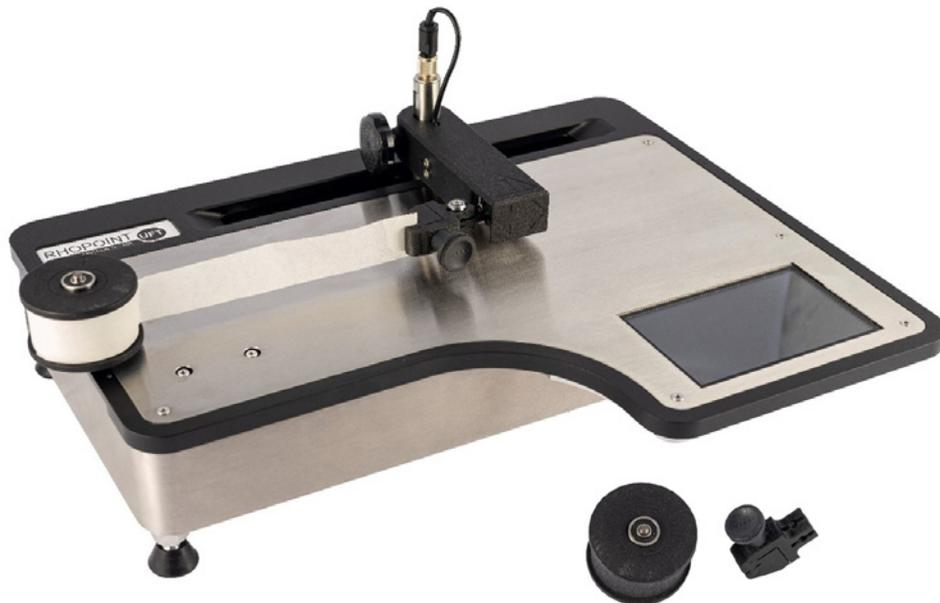
Für die 90°-Schälprüfung sollte der UFT wie in der obigen Abbildung gezeigt konfiguriert werden.
