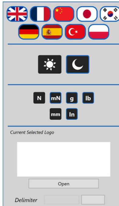
Auf diesem Bildschirm können Sie die Sprache, den hellen/dunklen Anzeigemodus und die Maßeinheit einstellen. Außerdem kann ein Firmenlogo/Kontaktdaten im .jpg-Format hochgeladen werden, das in allen Berichten verwendet werden kann. Die Größe kann in einem Verhältnis von 2084x248 Pixel sein. Solange das Verhältnis das gleiche ist, wird die Skalierung korrekt sein. Schließlich kann noch das Trennzeichen für die Daten festgelegt werden.
