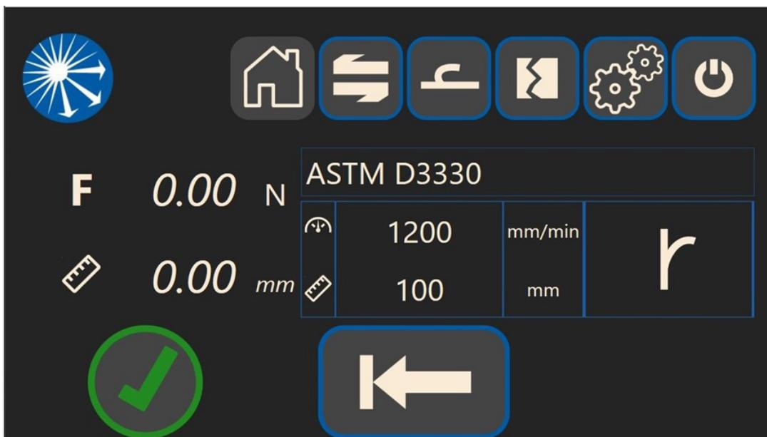
Wenn der Test erfolgreich abgeschlossen wurde, wird der folgende Bildschirm angezeigt und die Kraft und die Teststrecke werden auf der linken Seite des Bildschirms angezeigt.
