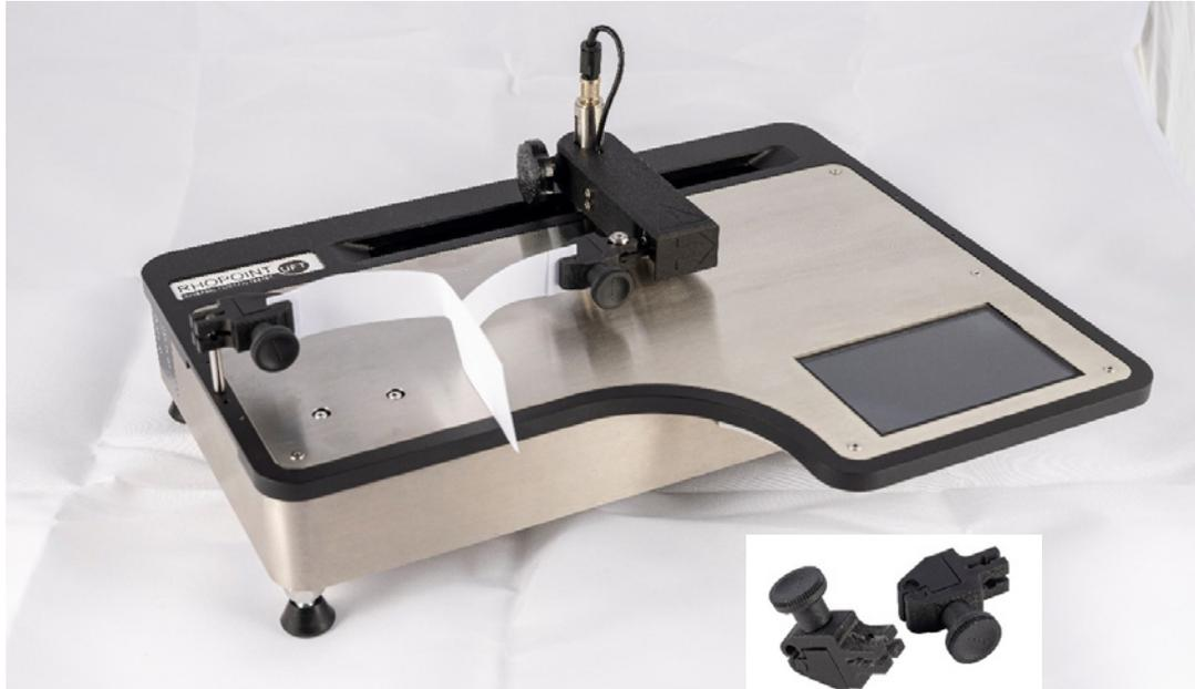
Für den Aufreißtest sollte der UFT wie in der obigen Abbildung gezeigt konfiguriert werden.
