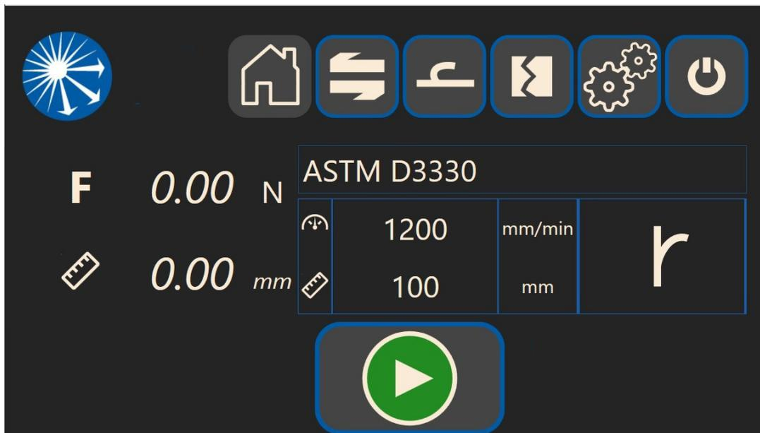
Drücken Sie die Taste
