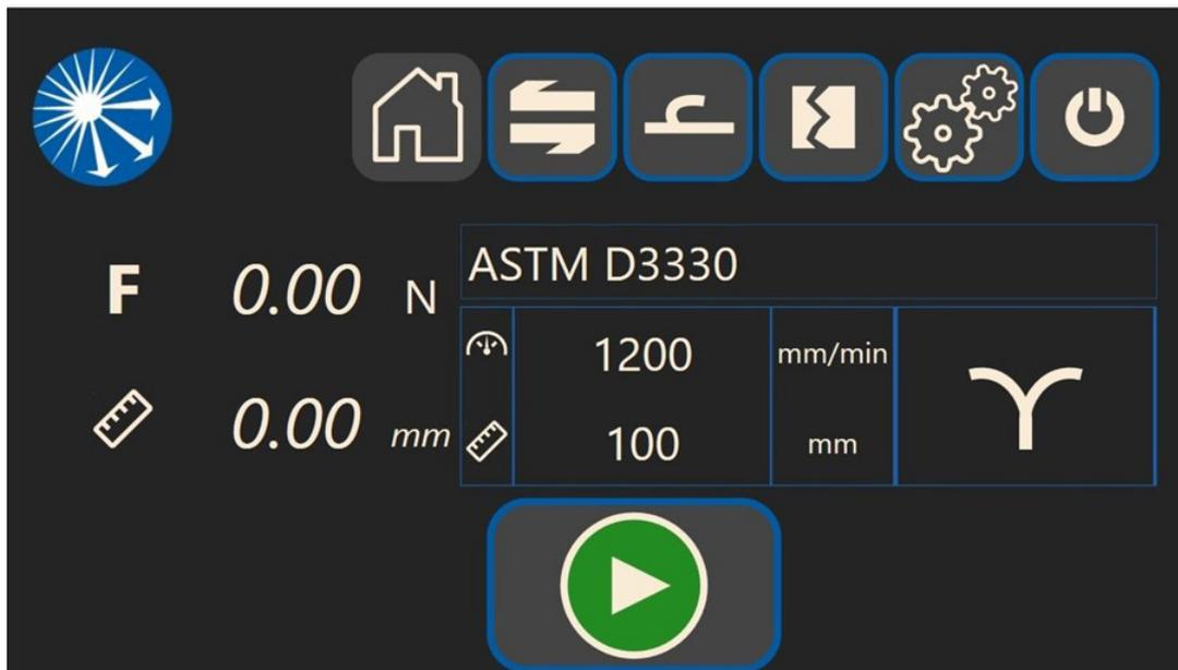
Drücken Sie die Taste
